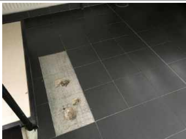
Prélèvement - P1 : DSDEN 08 / Rez-de-Chaussée / Hall d'Accueil - Colle de carrelage- (Absence d'amiante)
